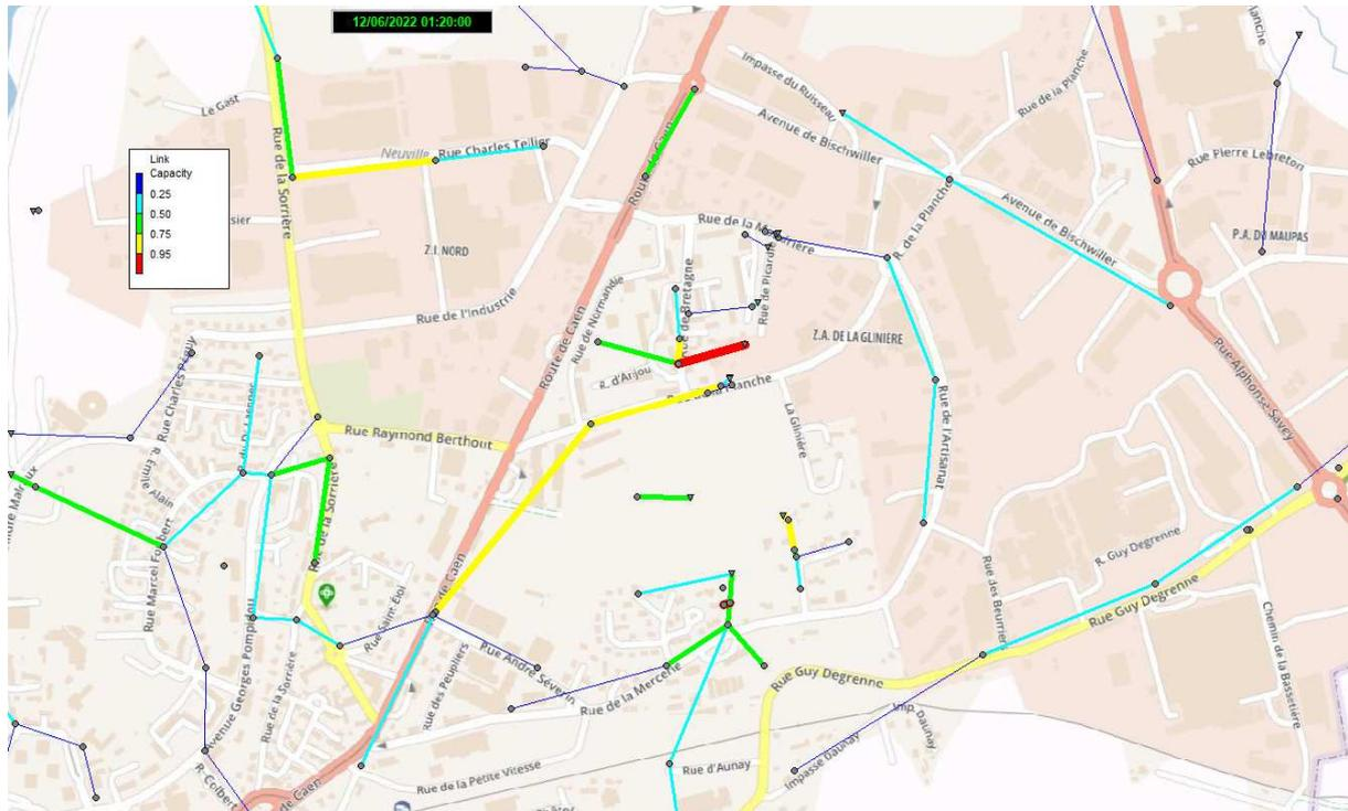
Pour le BV n° 51, le réseau est en limite de charge.
